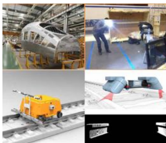
非理想偏振光源方法实现高铁车身及轨道测量
