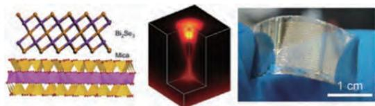
基于拓扑绝缘体纳米结构的柔性透明导电薄膜
